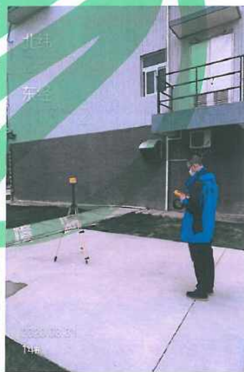
图 1.15 项目监测点 14# (距输出电缆渠 2 米, 距变电站 5 米)
