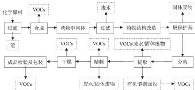
图2.3-1 化学合成类制药典型生产工艺及VOCs排放环节
