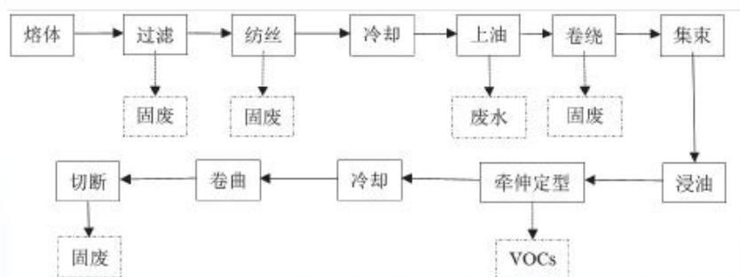
图2.12-7 涤纶短纤纺丝生产工艺及VOCs排放环节
