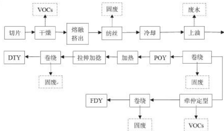
图2.12-5 涤纶6POY、FDY和DTY长丝纺丝生产工艺及VOCs排放环节
