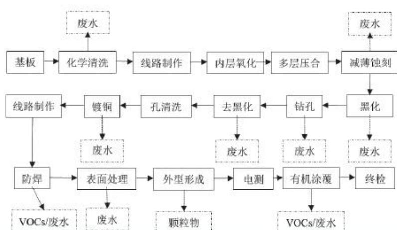
图2.9-7 印制线路板典型生产工艺及VOCs排放环节
