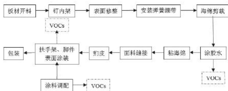
图2.7-2 软体家具制造业典型生产工艺及VOCs排放环节
