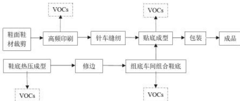
图2.6-1 制鞋行业典型生产工艺及VOCs排放环节
