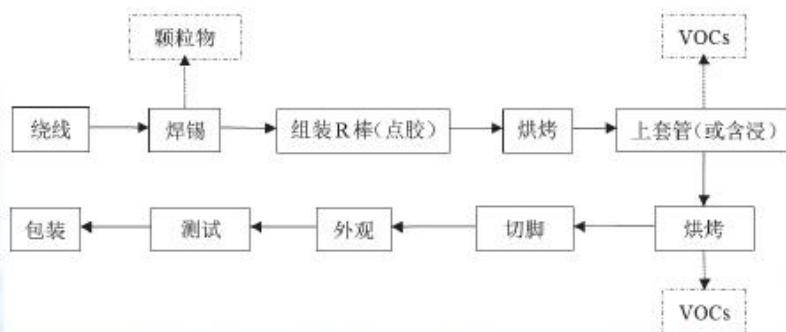
图2.9-5 电感器典型生产工艺及VOCs排放环节
