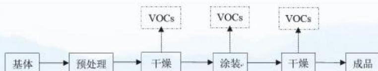
图2.4-3 金属制造及其他表面涂装典型生产工艺及VOCs排放环节
