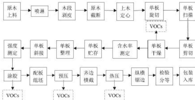
图2.8-1 胶合板制造典型生产工艺及VOCs排放环节
