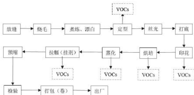
图2.11-2 印花典型生产工艺及VOCs排放环节
