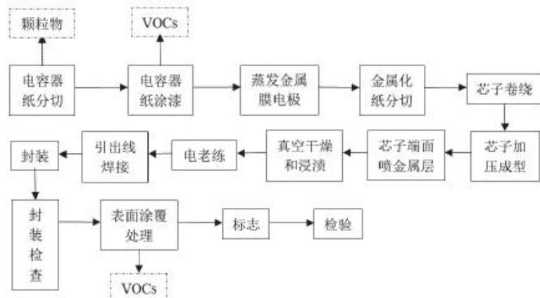
图2.9-1 有机介质电容器典型生产工艺及VOCs排放环节
