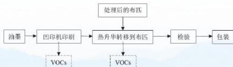
图2.11-3 凹印热升华转移印花典型生产工艺及VOCs排放环节
