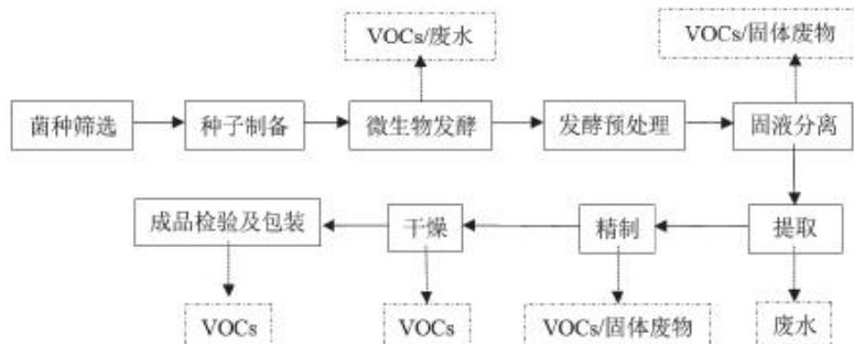
图2.3-2 发酵制药典型生产工艺及VOCs排放环节
