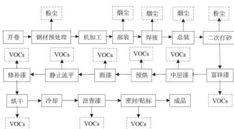
图2.4-2 集装箱制造典型生产工艺及VOCs排放环节
