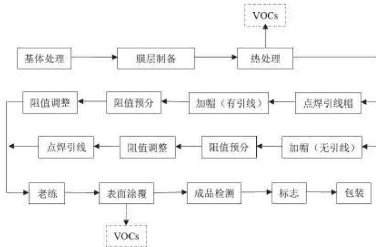
图2.9-3 薄膜电阻典型生产工艺及VOCs排放环节
