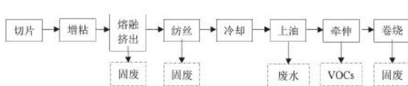
图2.12-6 涤纶工业纺丝生产工艺及VOCs排放环节
