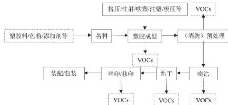
图2.10-2 塑料制品典型生产工艺及VOCs排放环节
