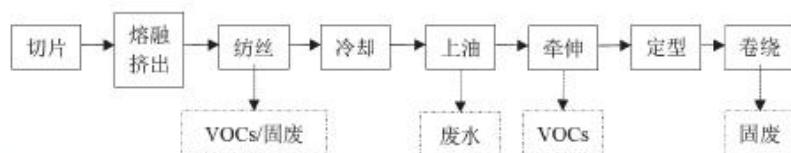
图2.12-3 锦纶工业纺丝阶段生产工艺及VOCs排放环节
