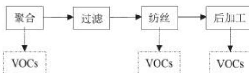
图2.12-15 其他合成纤维生产工艺及VOCs排放环节
