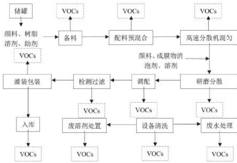
图2.2-1 涂料与油墨制造等典型生产工艺及VOCs排放环节
