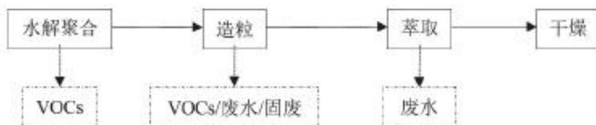
图2.12-1 锦纶6聚合生产工艺及VOCs排放环节
