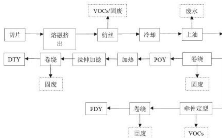
图2.12-2 锦纶6POY、FDY和DTY纺丝阶段生产工艺及VOCs排放环节
