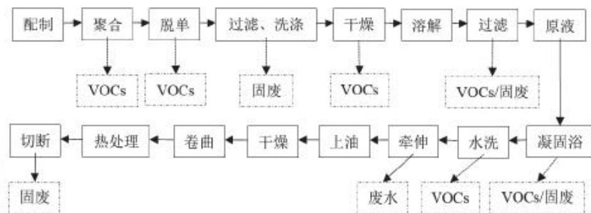
图2.12-10 DMAc湿法二步法生产工艺及VOCs排放环节
