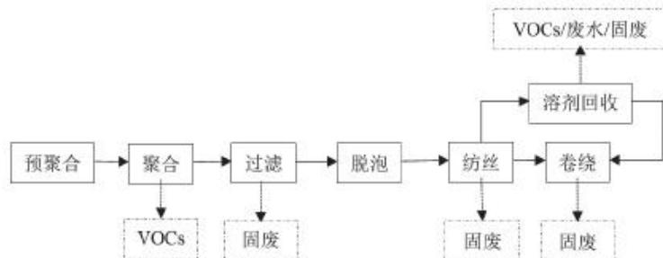
图2.12-11 氨纶生产工艺及VOCs排放环节
