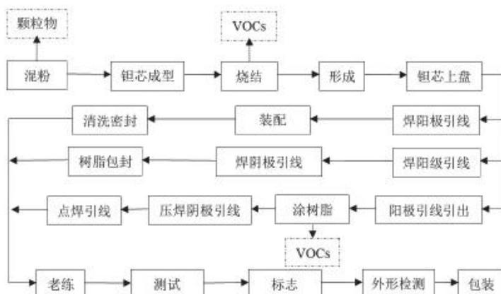
图2.9-2 钨电解电容器典型生产工艺及VOCs排放环节
