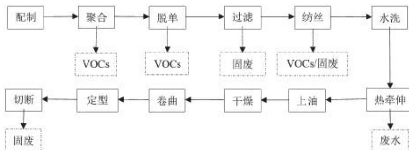
图2.12-9 NaSCN湿法一步法生产工艺及VOCs排放环节
