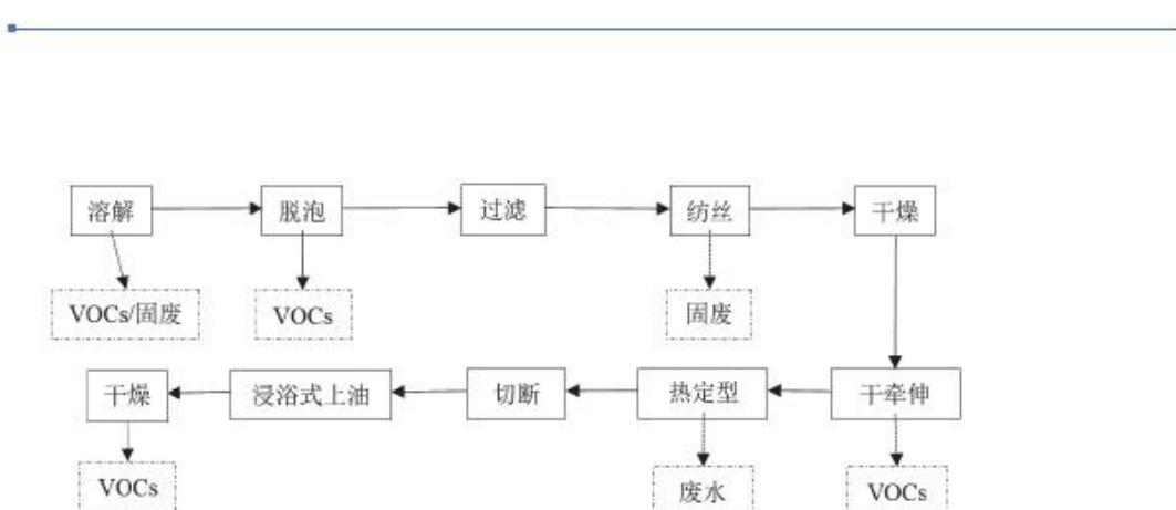
图2.12-14 维纶水溶型纺丝生产工艺及VOCs排放环节
