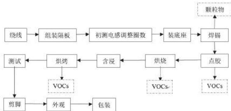
图2.9-6 电子变压器典型生产工艺及VOCs排放环节
