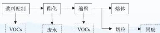
图2.12-4 涤纶聚合阶段生产工艺及VOCs排放环节
