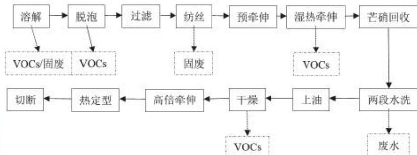
图2.12-13 维纶高强高模纺丝生产工艺及VOCs排放环节
