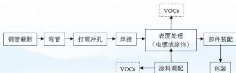
图2.7-3 金属家具制造业典型生产工艺及VOCs排放环节
