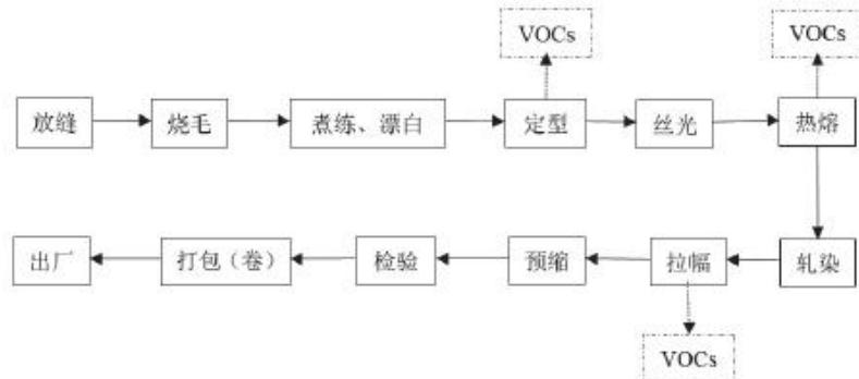
图2.11-1 染色典型生产工艺及VOCs排放环节
