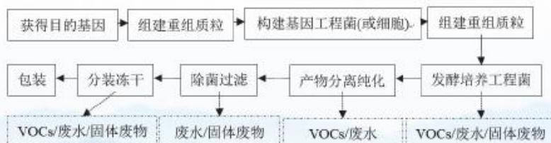
图2.3-3 生物工程类制药典型生产工艺及VOCs排放环节
