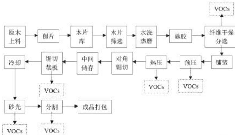
图2.8-2 纤维板制造典型生产工艺及VOCs排放环节
