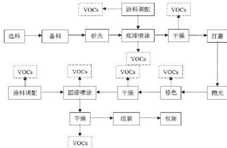
图2.7-1 木质家具制造业典型生产工艺及VOCs排放环节
