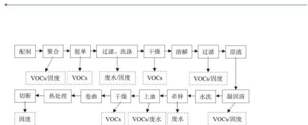
图2.12-8 NaSCN湿法二步法生产工艺及VOCs排放环节
