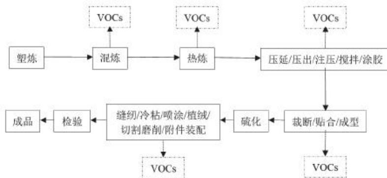
图2.10-1 橡胶制品典型生产工艺及VOCs排放环节
