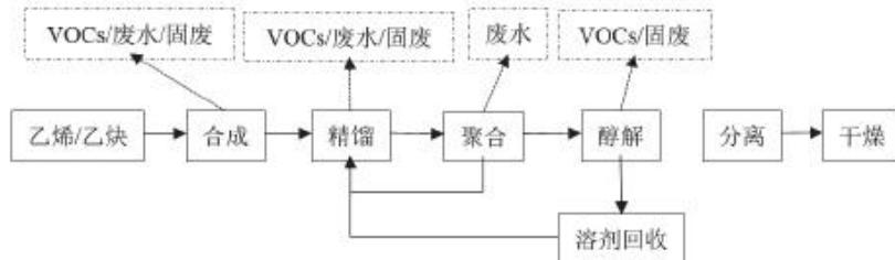
图2.12-12 维纶聚合生产工艺及VOCs排放环节
