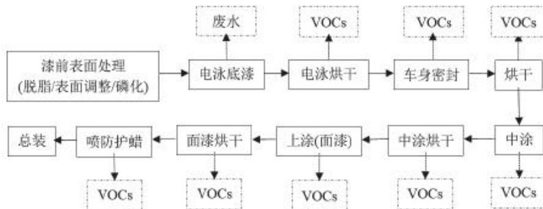
图2.4-1 汽车制造典型生产工艺及VOCs排放环节
