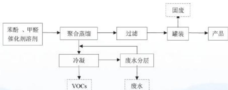
图2.2-2 溶剂型胶粘剂生产工艺及VOCs排放环节
