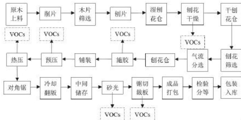
图2.8-3 刨花板制造典型生产工艺及VOCs排放环节
