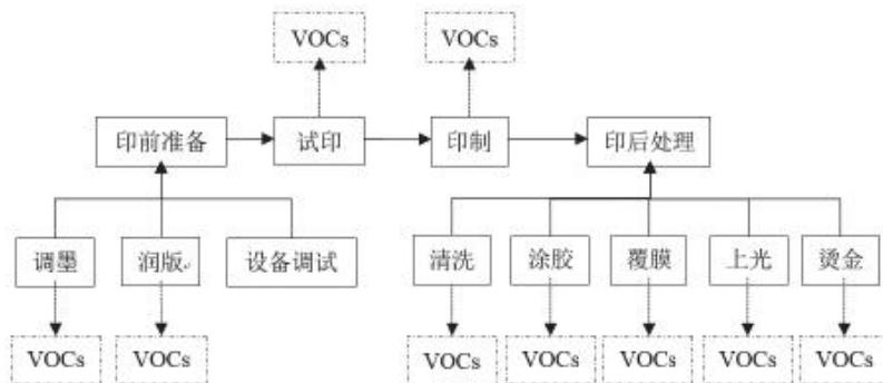
图2.5-1 印刷行业典型生产工艺及VOCs排放环节
