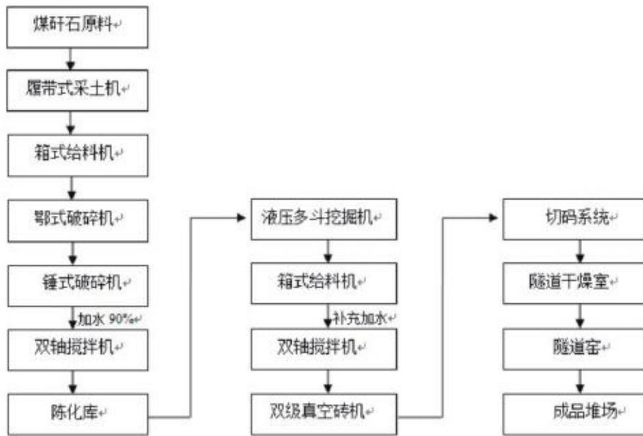
图 5-11 多孔砖生产工艺流程图
