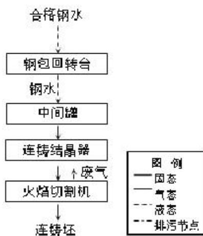
图5-6 连铸工序产污环节
