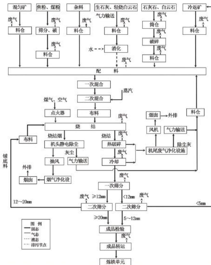
图5-1 烧结生产工艺流程及排污节点图
